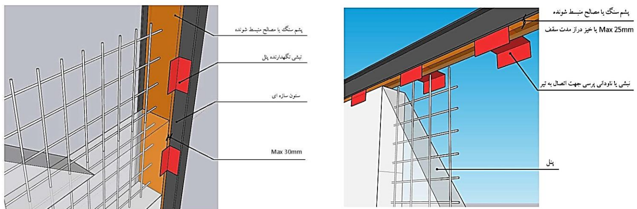
شکل ۲- جزئیات اجرایی پانل
